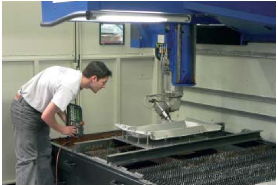
Soudage laser. Alternative au rivetage ? Cette technologie d'assemblage est développée en Aquitaine dans le cadre de l'action A400M.
