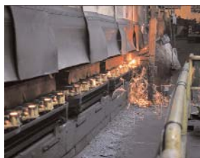
Coulée d'arbres à cannes
