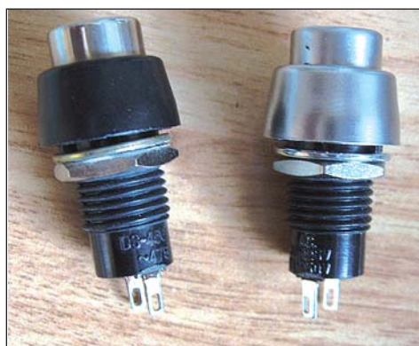
Bouton-poussoir pour hélicoptère VIP, avant et après métallisation
