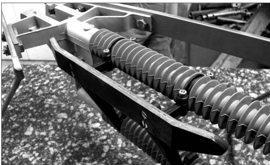
Leader mondial des isolateurs de section, Galland intègre sur ces pièces des patins isolants en composites
